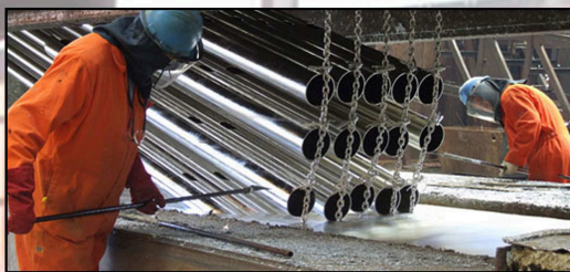
CARGAS MÁXIMAS DE UTILIZACIÓN Cadenas de eslabón corto, grado 4, para uso en plantas de galvanización.
